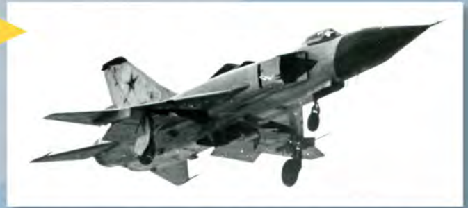
Le Soukhoï T-58VD, trappes supérieures ouvertes.
