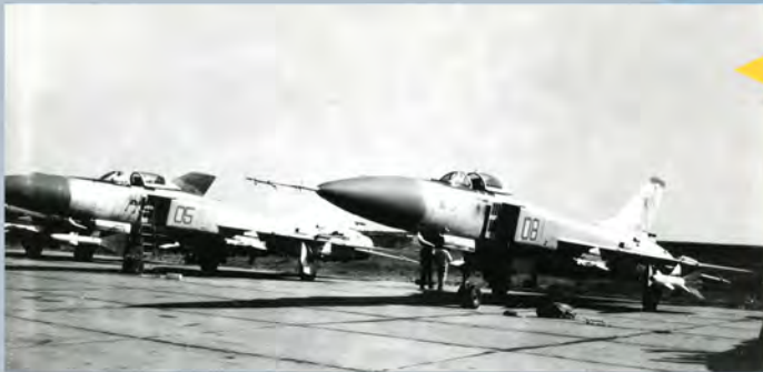
Deux Soukhoï Su-15TM aux extrémités de voilure modifiées.
