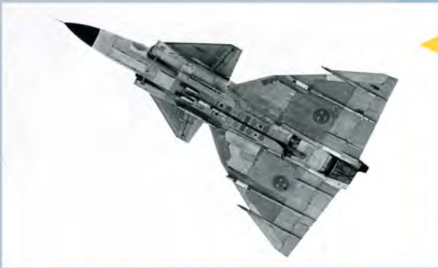
Les voilures caractéristiques du SAAB 37 "Viggen".
