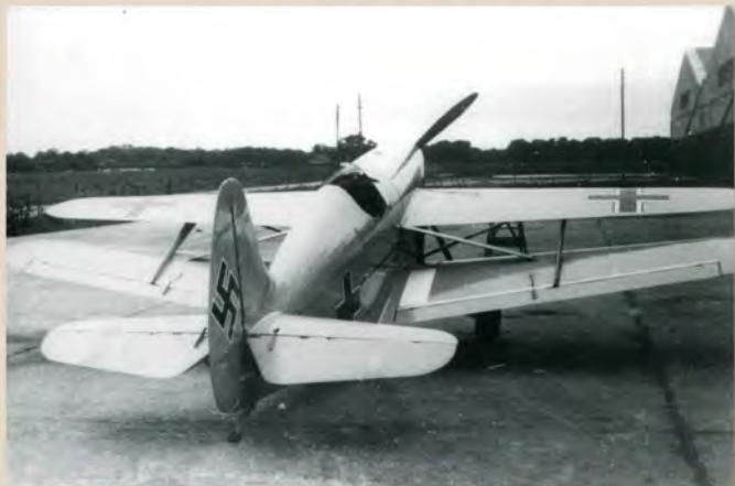
L'AS.20 d'André Starck, pourvu des doubles voilures Penadovitch, accomplit son premier vol à Villacoublay le 23 octobre 1942. Ramené en usine pour modifications, il y restera.
