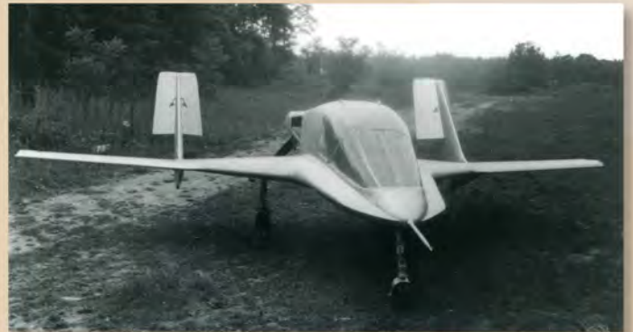
Le Pa.61F avec ses volets de direction « crocodile » ouverts.
