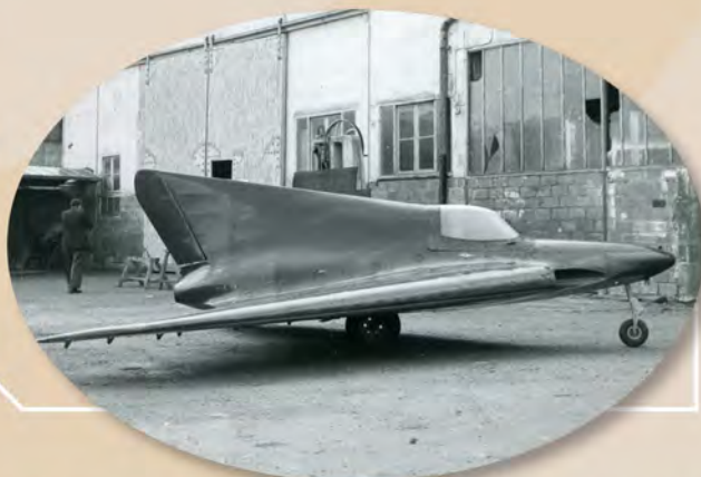
Le Pa.49A est prévu à l'origine avec un train monorail.
