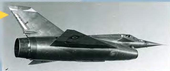
Le Nord N.1500 "Griffon" n°02 pourvu de plans canard avant.
