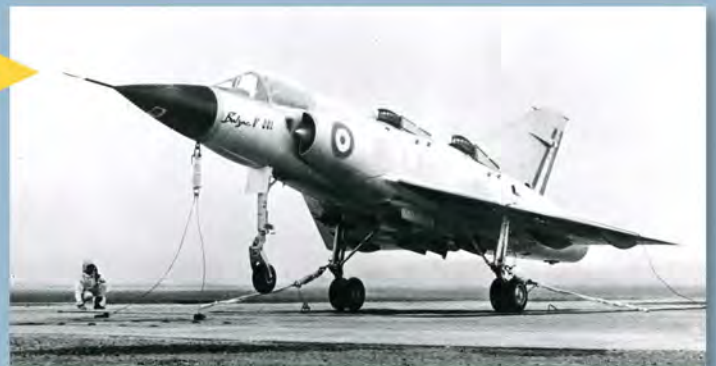
Le Dassault Balzac V n°001 au cours d'un vol d'essai entravé.
